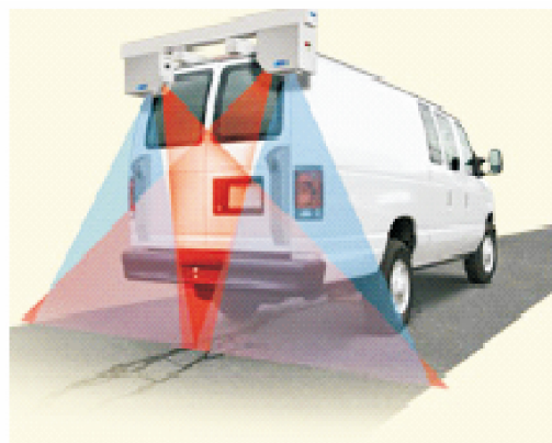
图 1 激光线扫描成像系统
